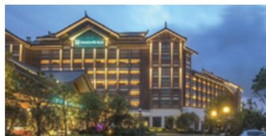
泛光照明手法，屋顶增加了大面积的泛光灯照明，为体现层次感和立体感，立面使用投光灯作为点缀。
