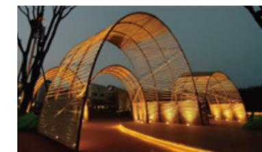
对于拱门类型的构筑物，使用投光的形式，利用埋地式灯具打亮构筑物，作为行人穿越的基础灯光。
