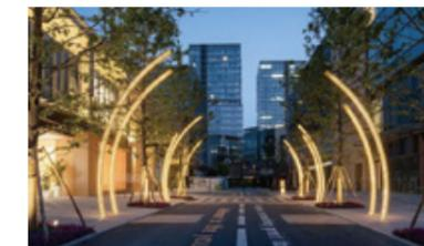
对于体型较小的乔木，采用投射灯从主干根部向上投射的方式，呈现不同的光影效果。路面增加发光造型装置，打破单调性。
