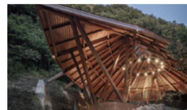
在凉亭中使用大面积的泛光照明，利用内部结构隐藏安装灯具展示内部结构的建筑美感。
