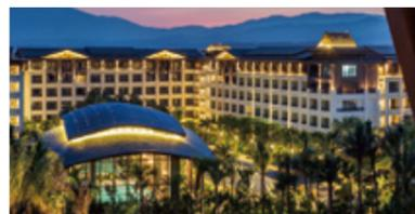
局部泛光照明手法，灯光主要集中在建筑中上部分，塑造局部建筑结构，主次分明，具有个性化。
