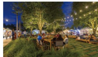
对于枝干比较茂盛的植被，采用投光灯安装于枝干之间投射的内透光照明方式，营造出枝叶发光的效果。树群之前设置装饰灯具，给游客提供舒适的休闲空间。
