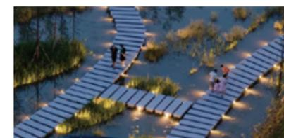
安装在栈桥底的灯具朝桥底照射——避免水面上产生巨大的镜面反射。
