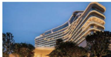
轮廓照明手法，灯光沿建筑形态而设，强化轮廓，展现建筑的线性美感。
