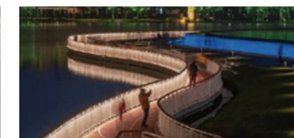
灯具暗藏于栏杆底部往上/往下洗亮扶手结构,连续且均匀地形成了导向性的引导。
