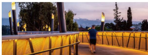
采用线性照明方式, 灯具沿护栏结构中而设, 作为基础灯光的同时也达到引导行人的作用。根据观赏需要, 适当配置符合景区风格的景观灯作为装饰, 使得场景内容丰富饱满, 有层次感。
